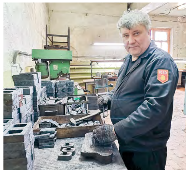
Электрообмотчик Владимир Петрашов работает на заводе 26 лет. Камера фотографа застала его за подготовкой сердечников для трансформаторов.
