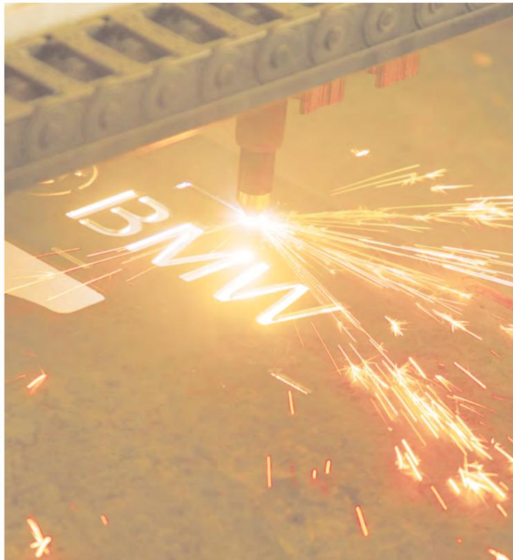
необходимую программу, содержащую чертеж детали, которую станок вырезает из металла.
